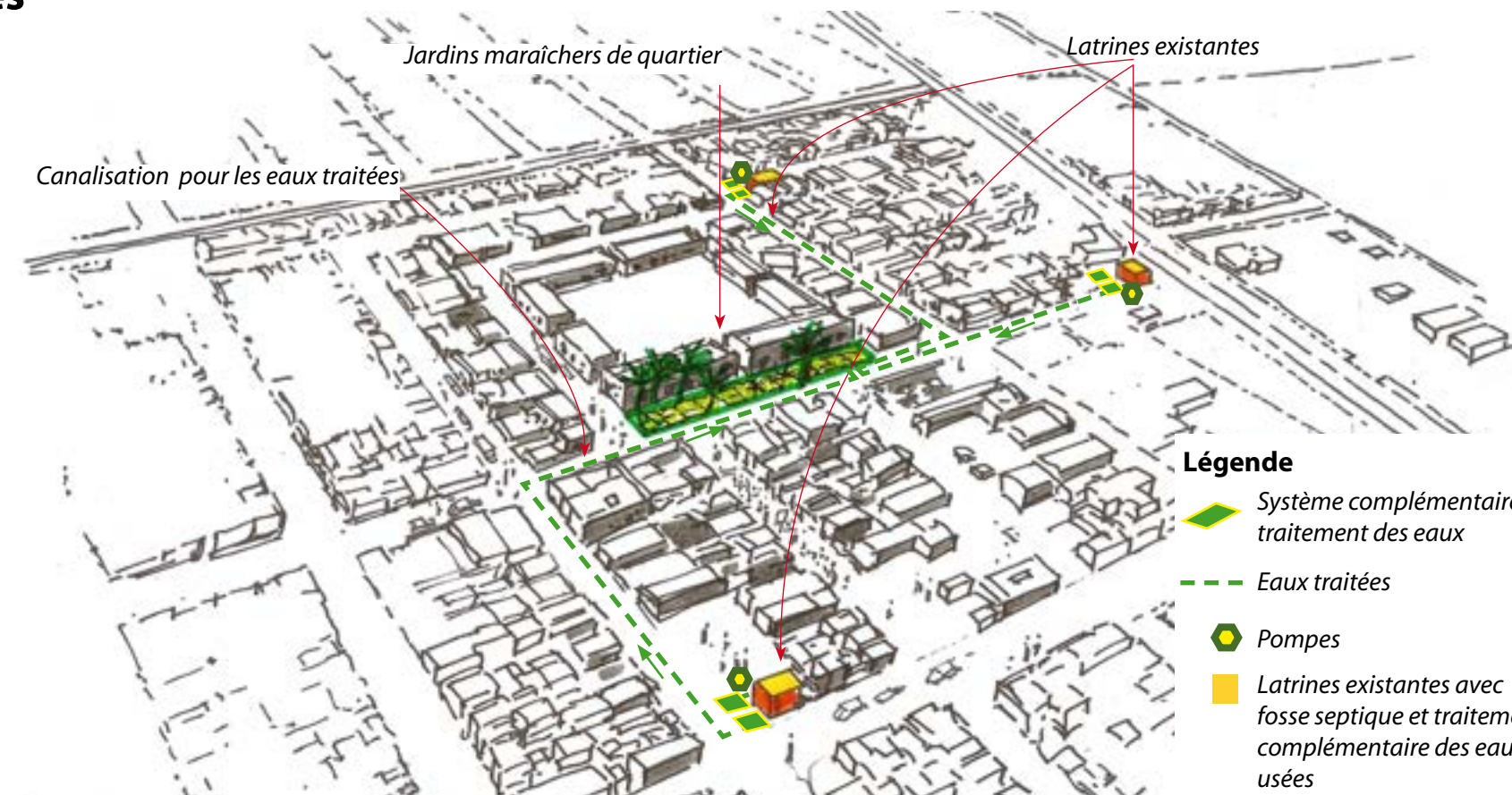
Raccordement des eaux usées depuis les latrines jusqu'à l'irrigation de jardins maraîchers
